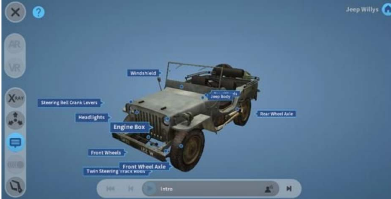
Imagen 2: Lección Jeep Willys para aprender sobre partes y ensamble de motor.
